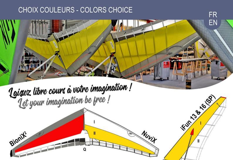
Bord d'attaque (Leading edge) Intrados avant (Front under surface) Intrados arrière (Rear under surface) Poche de quille (Keel pocket)
